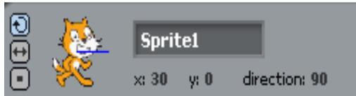
Der „x“ und „y“ Wert gibt die Position der Katze in der Bühne an. Wenn Du mit der Maus über die Bühne fährst, siehst du direkt unterhalb der Bühne die x, y Koordinaten der Mausspitze auf der Bühne.
